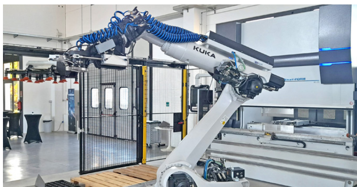
La cella di piegatura presente all'evento era costituita da una Easy Form 80/25 affiancata da un robot di Kuka
