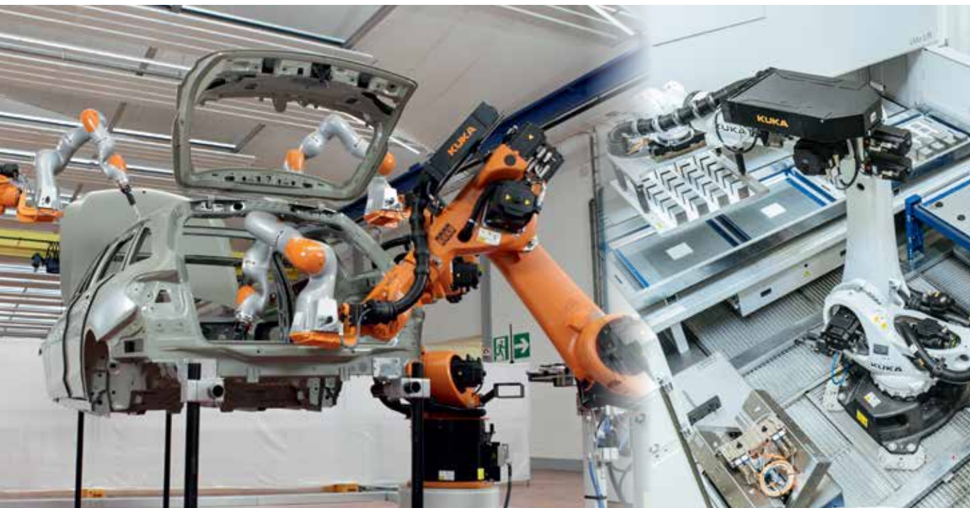
Nakładanie spoiwa i uszczelniaczy na nadwozie pojazdów
