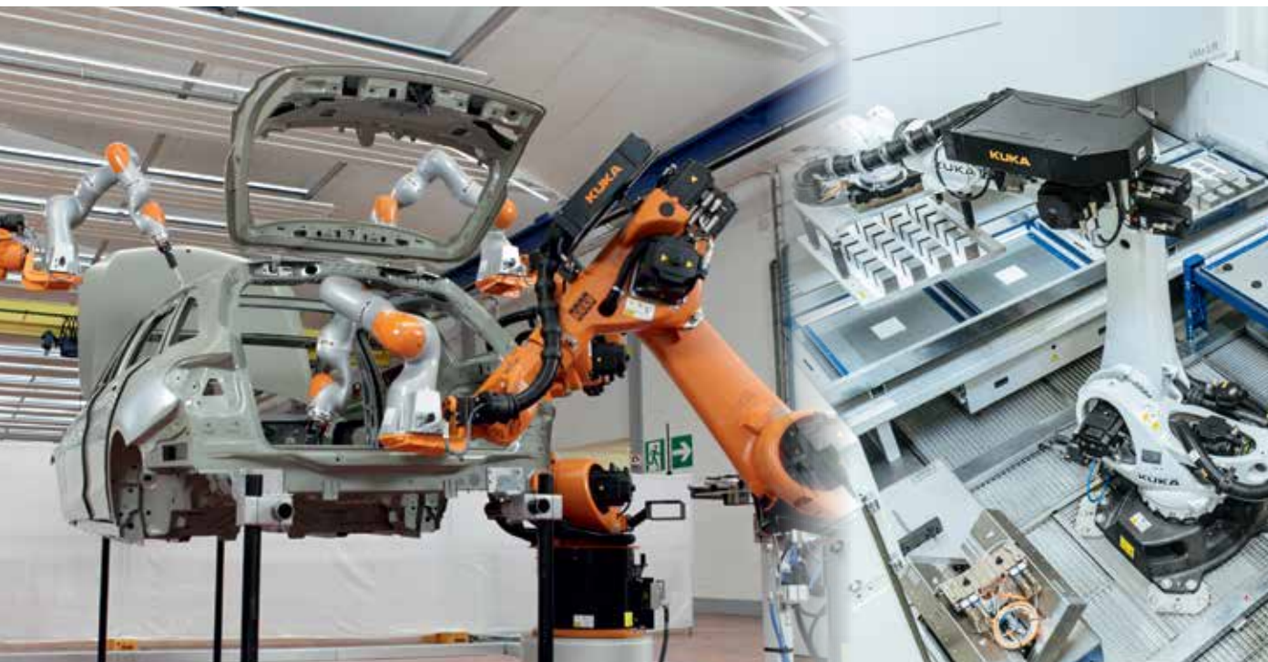
Application d'adhésif et d'enduits d'étanchéité sur la carrosserie du véhicule
