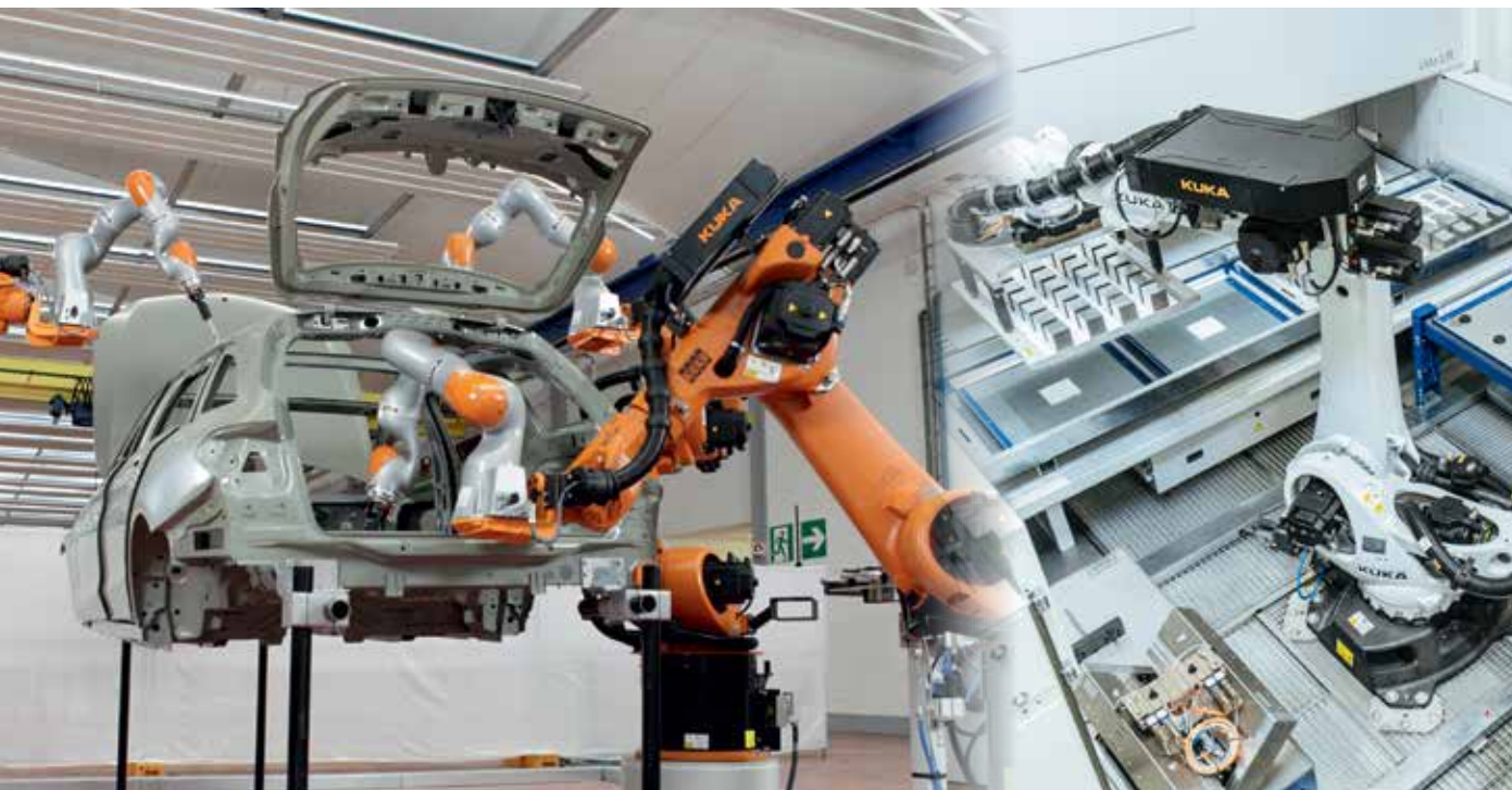
Aplicación de adhesivos y selladores a la carrocería del vehículo
