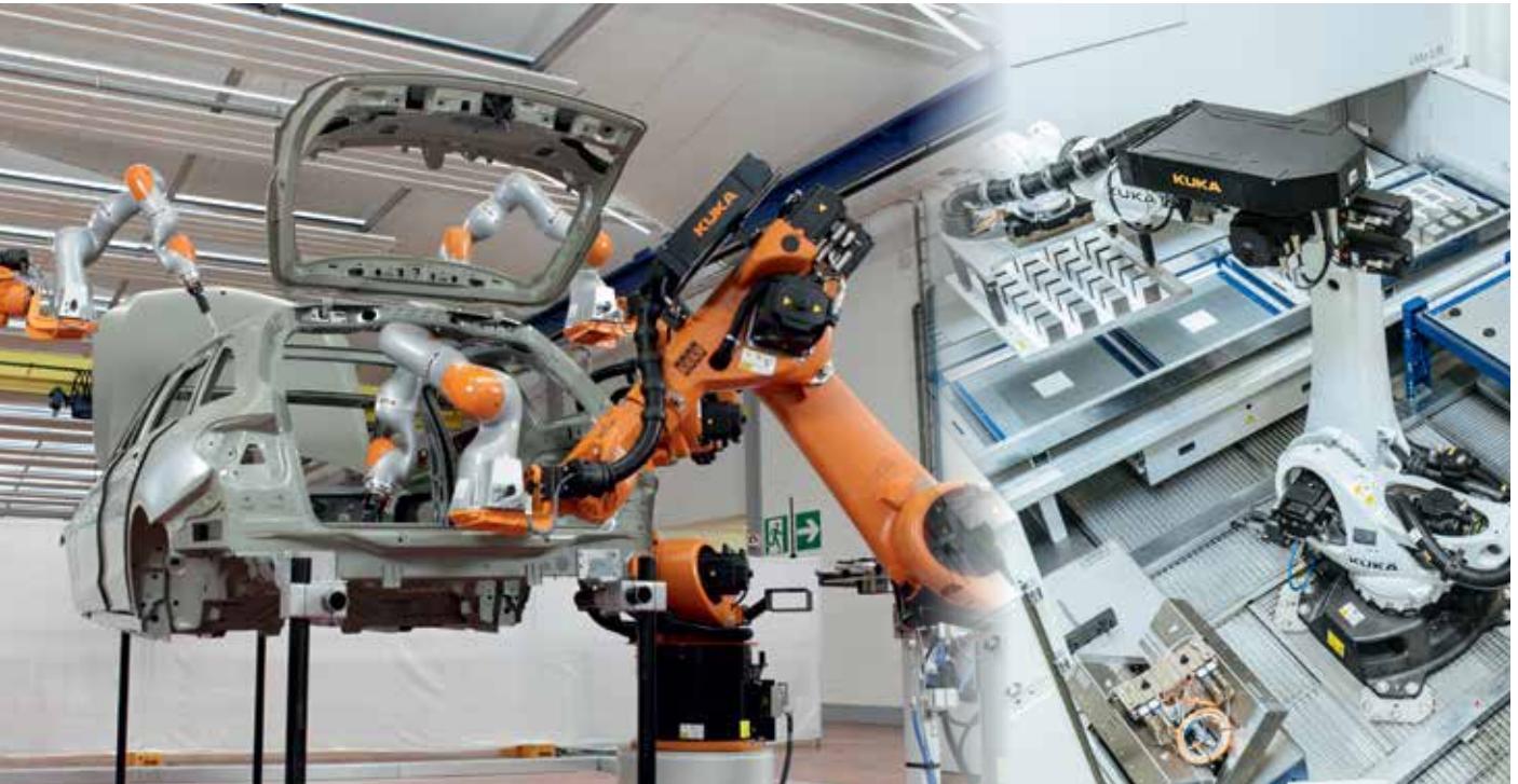
Auftragen von Dicht- und Klebstoffen auf die Fahrzeugkarosserie
