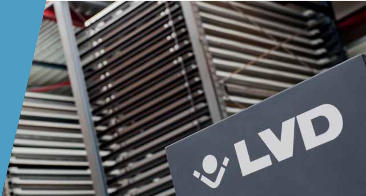
Das MOVit Lagerautomatisierungssystem (WAS) bietet die ultimative automatische Materiallagerung und -rückholung mit einer anpassbaren Anzahl von Turm-Lagereinheiten, beginnend mit mindestens vier Türmen, in einer ein- oder zweireihigen Konfiguration. Durch einen kontinuierlichen Fluss der Bleche sorgt WAS für eine unterbrechungsfreie Produktion sowie eine vollständig unbemannte Bedienung und kann an mehrere Laserschneidmaschinen in den Formaten 3015 oder 4020 angeschlossen werden.
