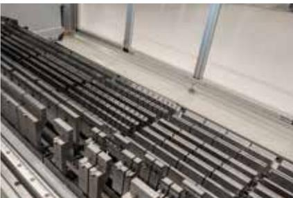
Ein Ständerwerk für zwei komplette Längen von Stempeln und fünf komplette Längen von Matrizen ist innerhalb der Maschine integriert.
