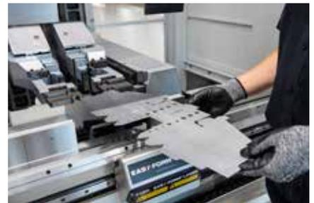
Ein 6-Achsen-Hinteranschlag wird für optimale Biegeergebnisse automatisch positioniert.
