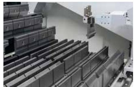
Der Hinteranschlag mit integrierten Greifern setzt Werkzeuge ein und entnimmt sie für ein schnelles Umrüsten und eine hohe Produktionsleistung.
