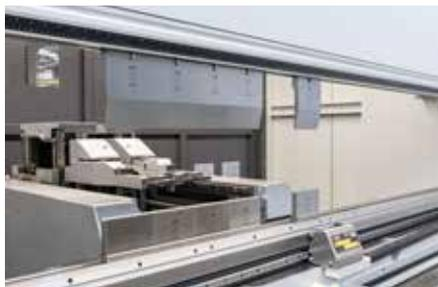
Schnellwirkende hydraulische OW-Klemmung
