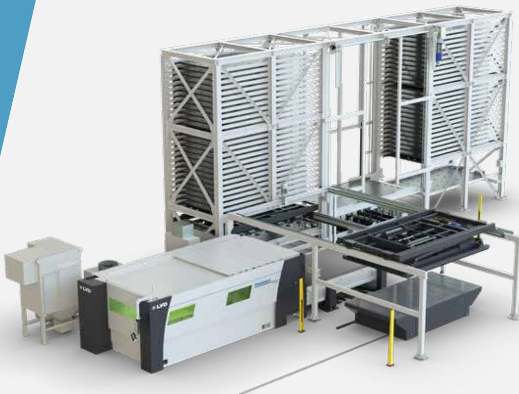
Le Système d'Automatisation de Tour MOVit TAS est un système à une ou deux tours qui peut être connecté à une ou deux machines de découpe laser de formats 3015, 4020 ou 6020. Proposé dans 16 configurations possibles, TAS offre un approvisionnement en matériaux constamment disponible, afin d'optimiser la production de la machine.
