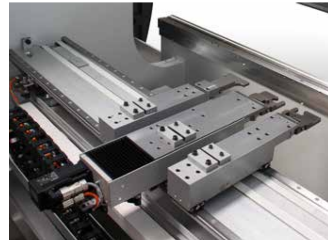
额外后档指用于测量长而小的条状工件
