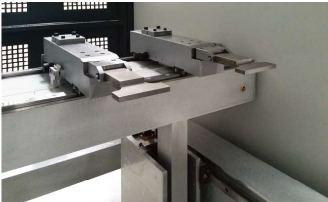
PPEB-4 및 PPEB-5 에서 수동 Z 축이 있는 표준 2 축 백 게이지 (X, R)
