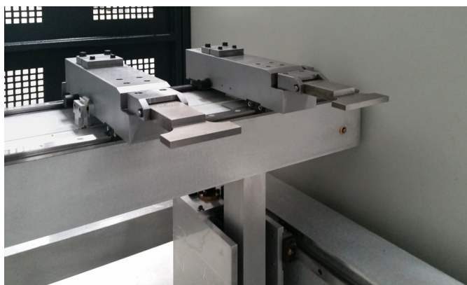
PPEB-4 和PPEB-5系列标配两轴后档料 (X,R) 带手工Z轴调整
