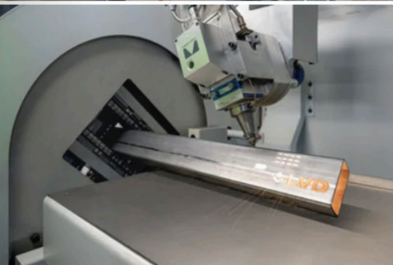
Il sistema di automazione del magazzino (WAS), la macchina Taurus con una potenza laser fino a 30 kW e un taglio di tubi con la TL8525.
