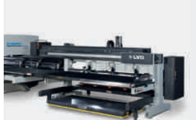
Automatisches Beladen/Entladen (PA)
