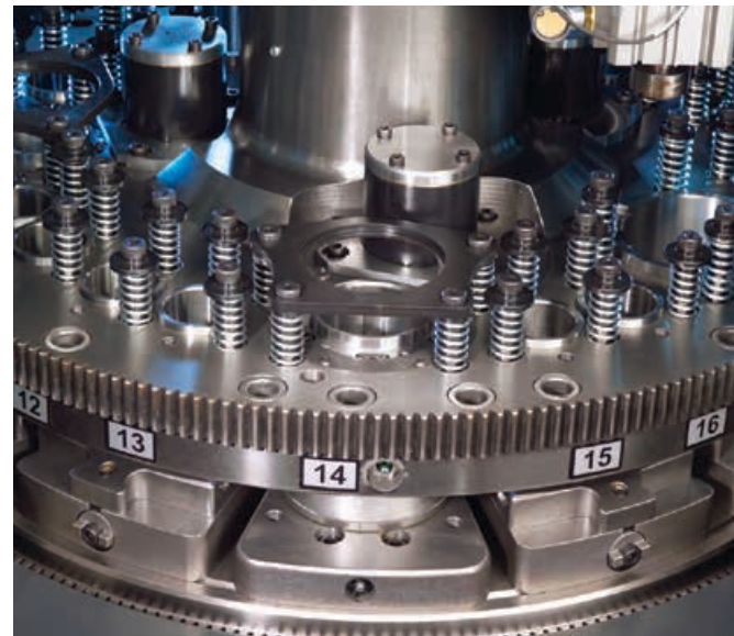
Busen van gehard staal verschaffen een doeltreffende gereedschapsgeleiding voor langere tijd; versleten of beschadigde busen kunnen gemakkelijk worden vervangen.
