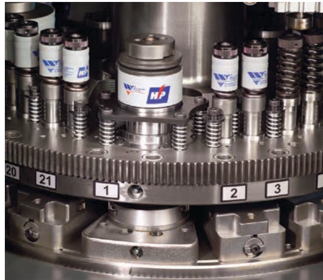
La configuration de la tourelle à 21 stations offre une grande flexibilité et une grande capacité.
