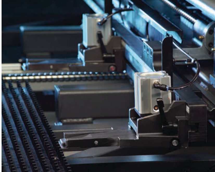
Le Smart Clamp minimise les zones de non-poinçonnage, réduit le nombre de repositionnements et diminue le taux de chutes matière.
