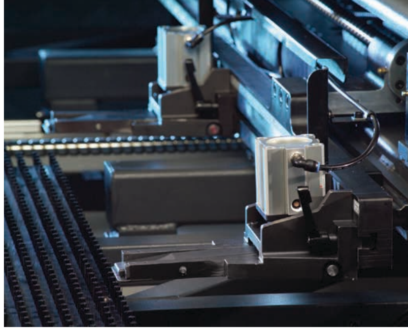
Smart Clamp minimiert die ungestanzten Zonen, um progressive Bewegungsanforderungen zu vermindern und die Materialausnutzung zu verbessern.
