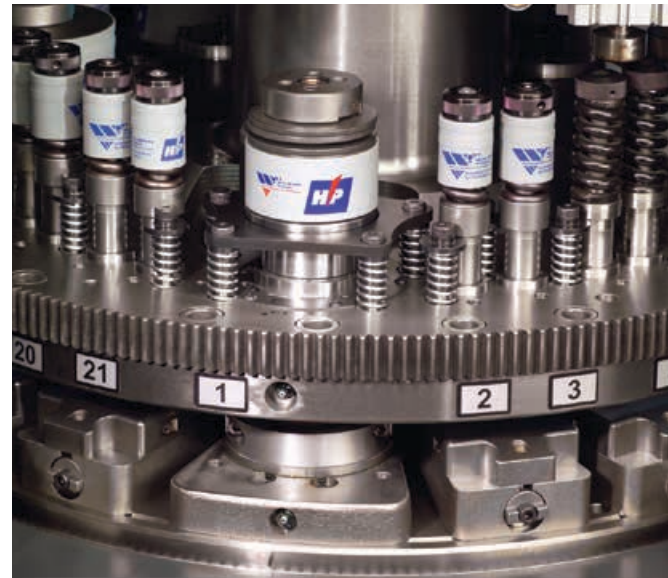
Eine 21-Stationen-Revolver-Konfiguration bietet außerordentliche Flexibilität und Kapazität.
