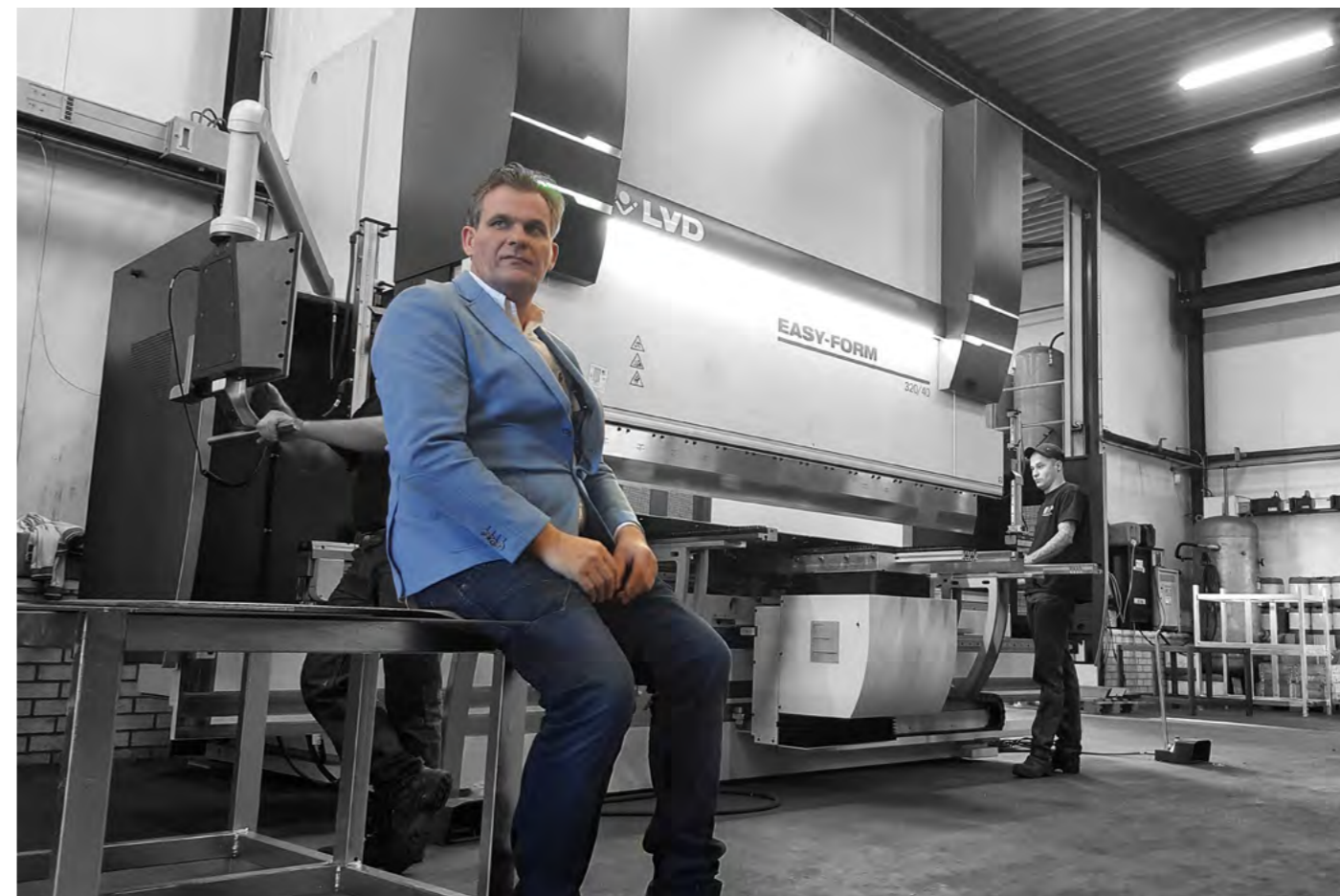
Raymond Woolderink bij de nieuwe Easyform kantpers (320 ton, 4 meter). "We kunnen kanten vanaf tekening, vanuit 3D model, maar ook ouderwets programmeren aan de bank. Dat is heel handig."
