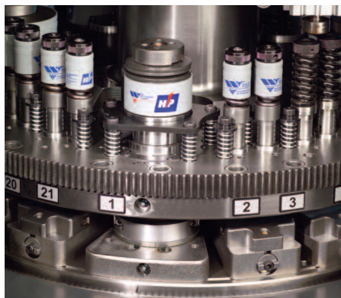
Een revolverconfiguratie met 21 stations biedt enorme flexibiliteit en capaciteit.
