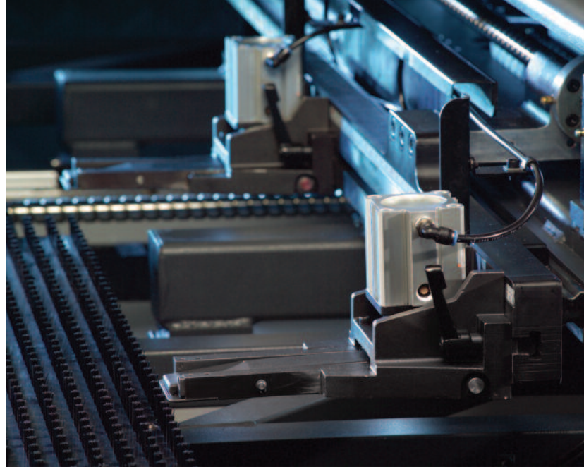
De Smart Clamp™ houdt de niet-ponsbare zones zo klein mogelijk om de behoefte aan progressieve verplaatsingen te beperken en het materiaalgebruik te verbeteren.
