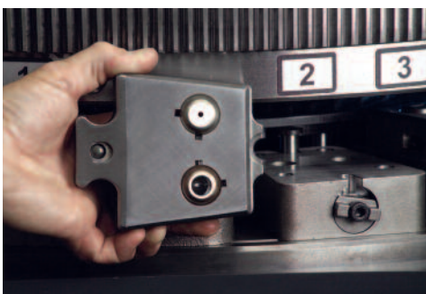
Snel verwisselbare matrijshouders reduceren de insteltijd en verhogen de productiviteit.
