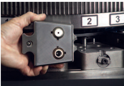
Erhöhung der Produktivität durch Verkürzung der Rüstzeit durch schnell austauschbare Matrizenhalter.
