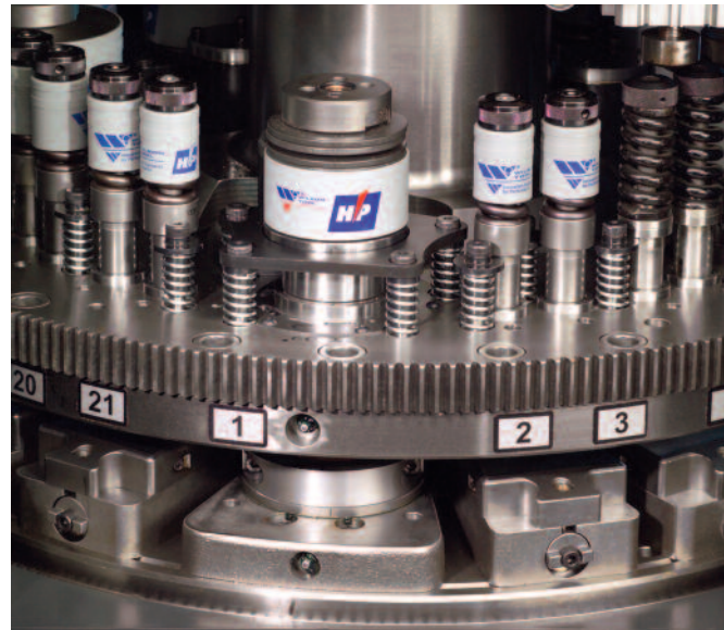
Eine 21-Stationen-Revolver-Konfiguration bietet außerordentliche Flexibilität und Kapazität.
