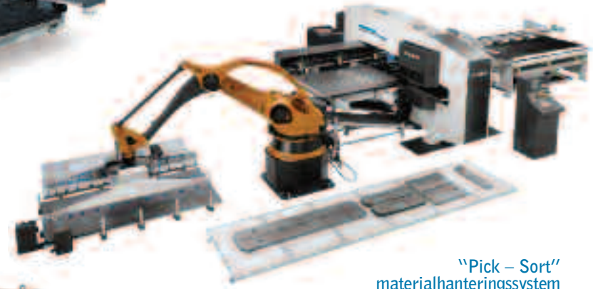
Strippit V Serie Full utrustad stansmaskin som kombinerar stor kapacitet i verktygshållaren med extra bra formning. Modeller i 20-30 ton.
