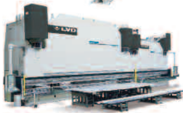
Zakázková provedení Vyvíjena pro speciální aplikace při ohraňování a stříhání. Speciální provedení ohraňovacích lisů (jednoduchých nebo tandemů) ve velikostech až do tonáže 3000 a 18 metrů pracovní délky.
