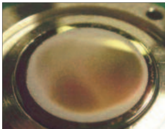
Der Resonatorspiegel ohne Zentrifugalabscheider. Um die Wirksamkeit des Wirbelstromreinigers zu überprüfen, wurde das Lasergas mit 5 gr. Glasstaub verunreinigt.
