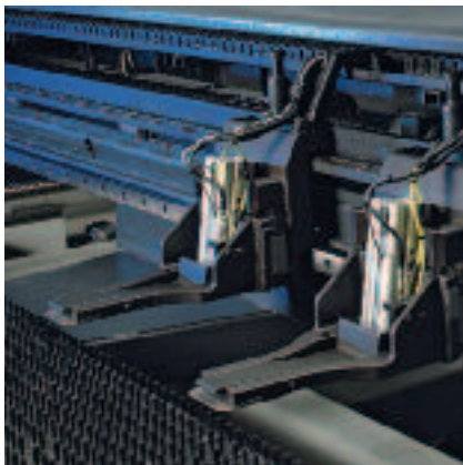
Programmeerbare plaatklemmen beperken of elimineren de niet-ponsbare zones.
