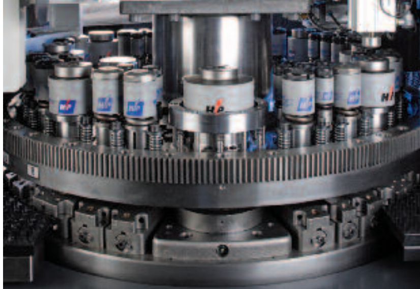
De revolver met grote capaciteit heeft tot 48 stations.
