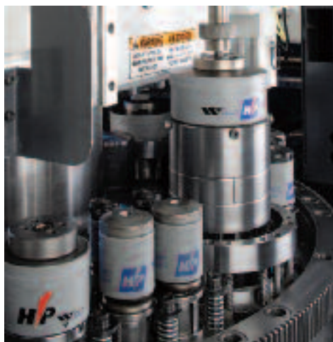
Een vast 114,30 mm station biedt ruimte aan grote doorsnijstempels, rolvormstempels of speciale vormen.
