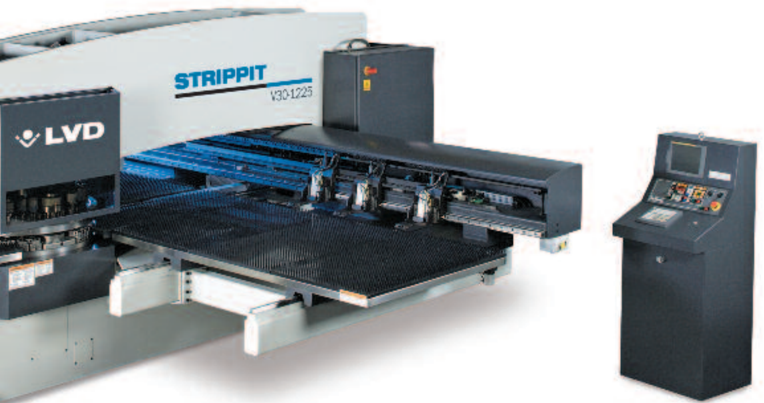
Strippit V-serie revolveerponsmachines zijn beschikbaar met een ponsvermogen van 200 of 300 kN.
