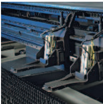
Les pinces programmables éliminent les zones de non-poinçonnage.
