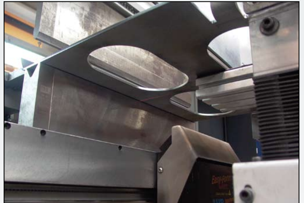
Het Easy-Form® Laser-systeem voor adaptief plooiën meet de plooihoek in real-time en zorgt voor juiste resultaten vanaf de eerste plooi.
