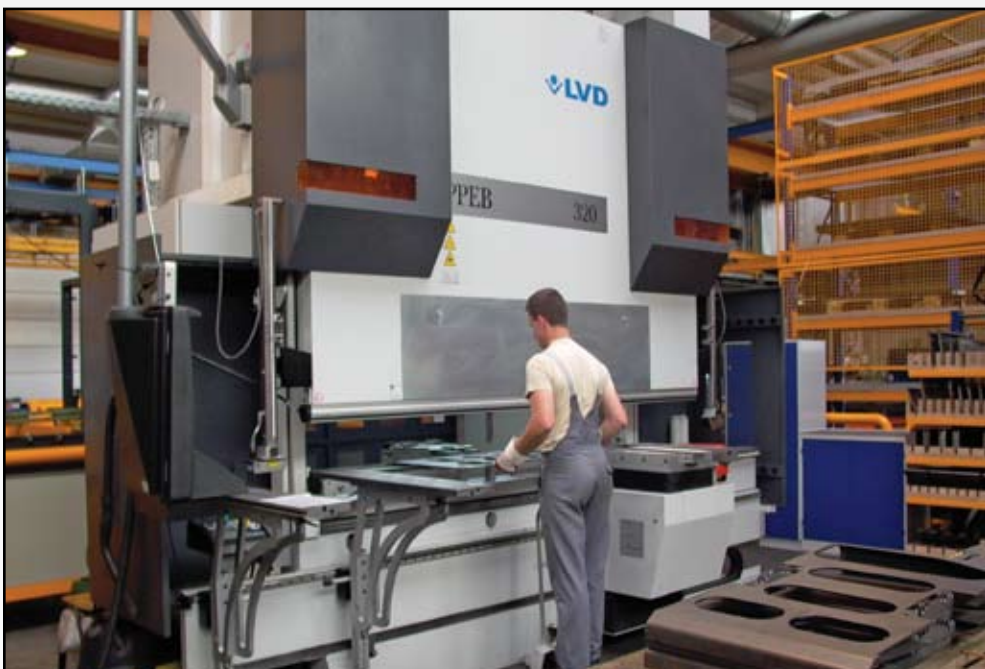
Jungheinrich gebruikt een Easy-Form® 320/30 afkantpers en CADMAN-B 3D programmeersoftware van LVD om stukken te vormen voor magazijntrucks.
