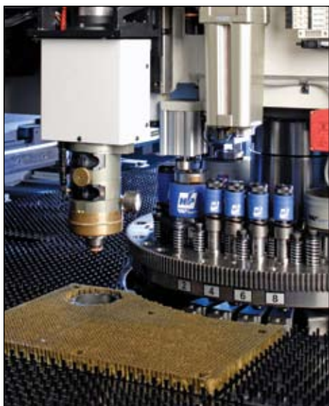
De Strippit LP-1225 is voorzien van een 33-stations revolver en 2,5 kW laser.
