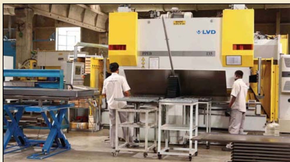
Rittal gebruikt vier LVD Easy-Form® Series afkantpersen met programmeerbaar T-as plaatvolgsysteem om grote platen uit aluminium, zacht staal en roestvrij staal nauwkeurig te plooiën.
