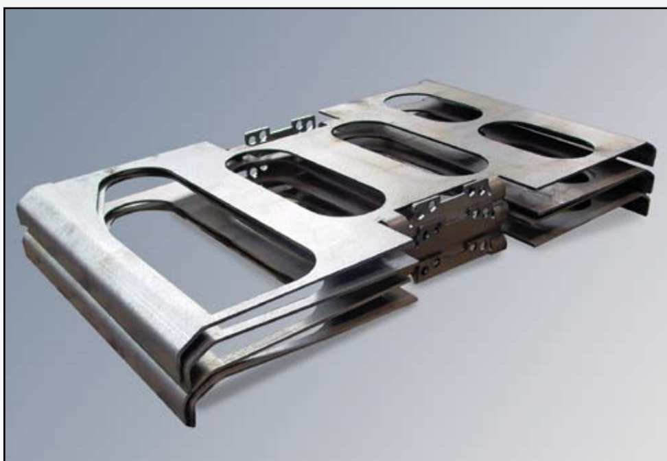
High-rack stapelaars worden vervaardigd uit plaatstukken die eerst gevormd en daarna samengegast worden om zo afgewerkte constructies te vormen zoals de cabine, de hefrichting, enz.
