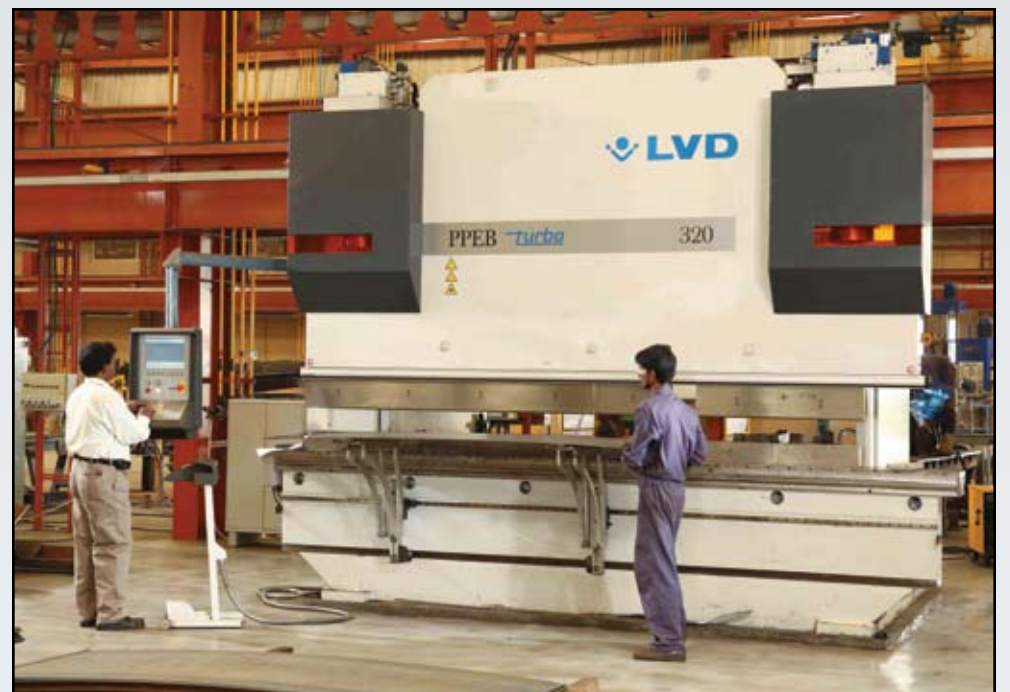
UMHECO gebruikt een 320/4000 mm PPEB-5 afkantpers om nauwkeurige plooiresultaten te verkrijgen bij de productie van onderdelen voor zware grondverzetmachines.
