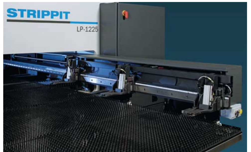
Een borsteltafel beperkt de geluidshinder en vermijdt krassen.
